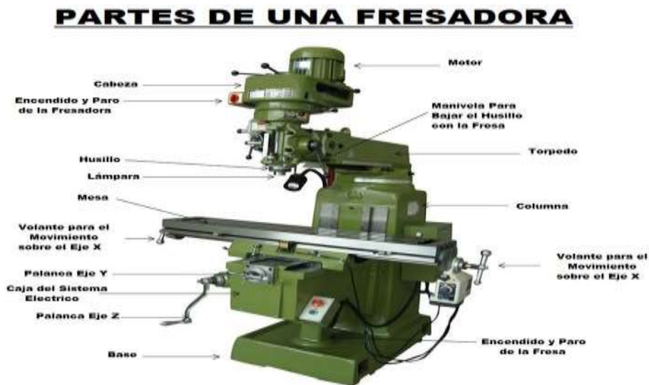
Fig. 5 Partes de Fresadora.
