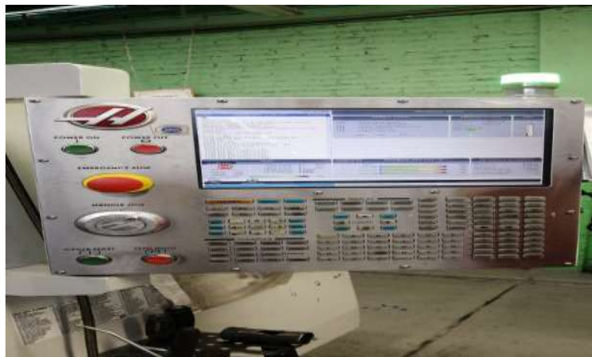
Fig. 18. Tablero de control de la máquina.
